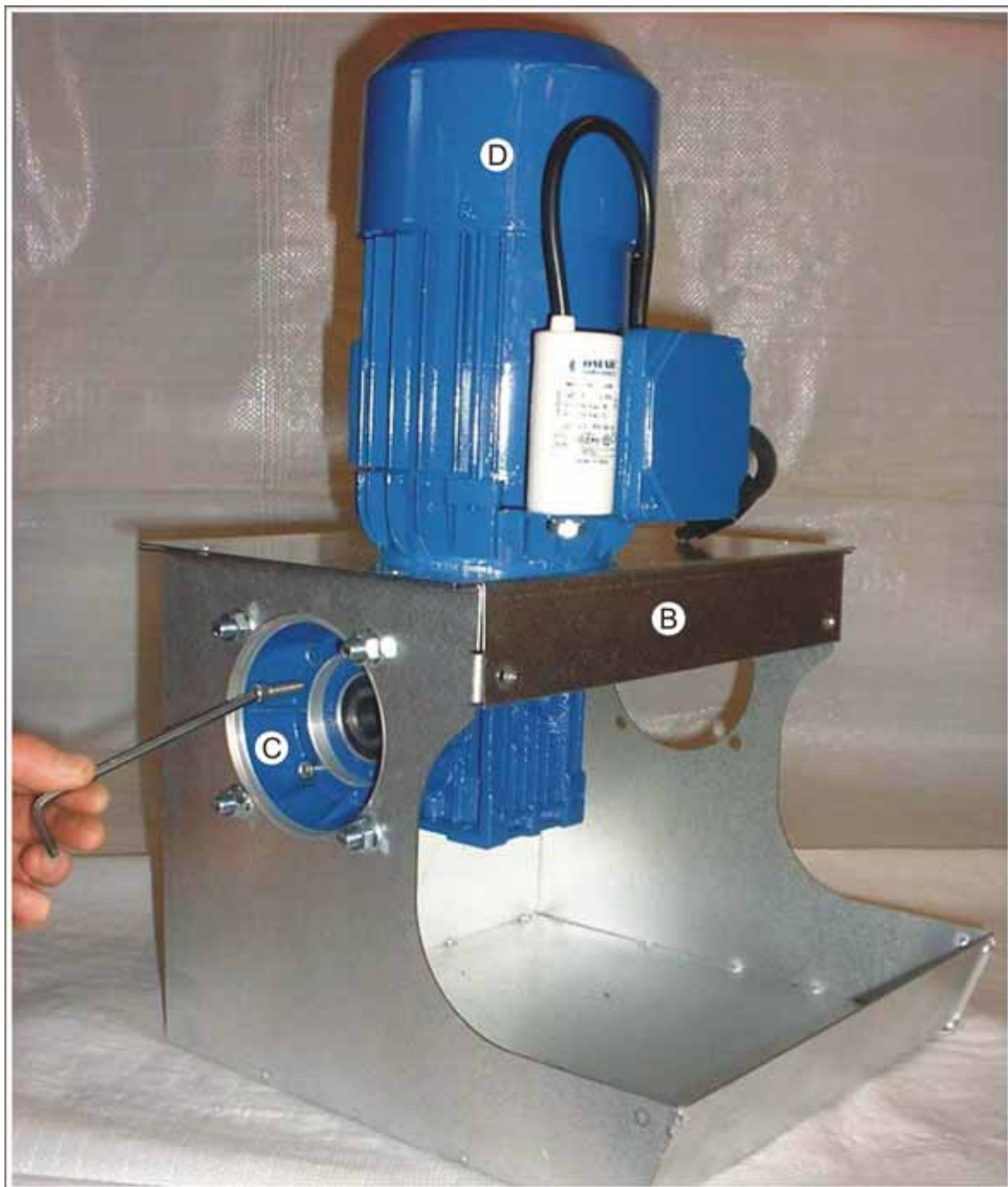
Figur 21: Montage av motor på utmatningslåda
