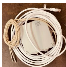
1599 Fördelningslåda till acktankstyrning Cc05 (PX22)
